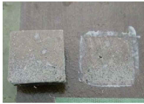
破断面にレイタンス
