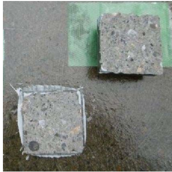
破断面にレイタンスなし
